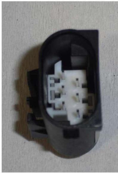
A- À INSTALLER DANS LE FAISCEAU DE CÂBLES À LA PLACE DU POTENTIOMÈTRE D'ACCÉLÉRATEUR.
