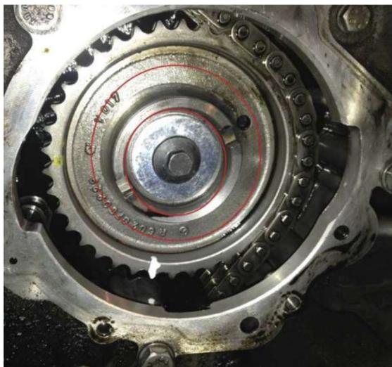
9. DÉVERROUILLER LA POMPE EN PRENANT SOIN DE POSITIONNER LA CALE SOUS LE BOULON DE DISTRIBUTION
