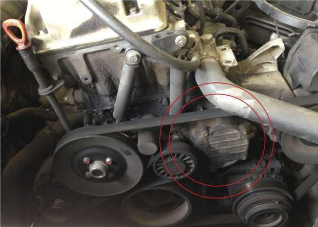
3. BLOQUER LE MOTEUR AU NIVEAU DU PREMIER CYLINDRE (CÔTÉ RADIATEUR) EN INSÉRANT UNE GOUPILLE SUR LE TROU DE RÉFÉRENCE DE L'ARBRE À CAMES DANS LE COMPARTIMENT DES POUSSOIRS. LE VOLANT MOTEUR ÉTANT EN POSITION DE OT.
